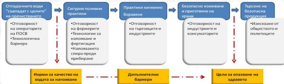
Фигура 1: Подход за контролиране качеството на водата
