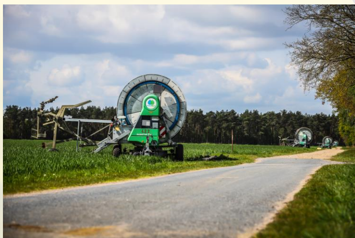
Figura 1: Macchine irrigue installate sui punti di presa
