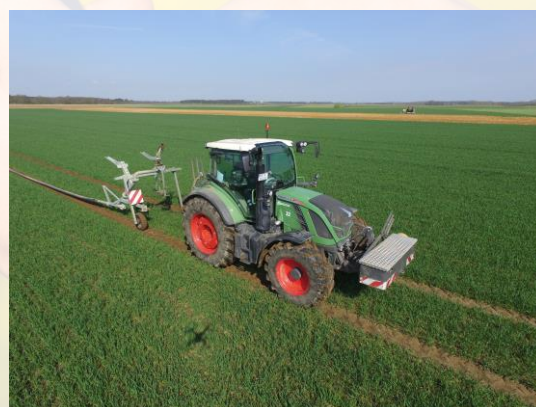
Figura 2: Sistema de rega de aspersão deslocado com tratores
